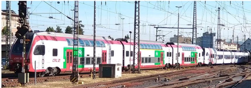
Gekuppelte Zugbildung aus einstöckigen und doppelstöckigen Triebwagen mit unterschiedlichen Zugzielen sind in Deutschland bereits erfolgreich in Betrieb (im Bild: Koblenz – Trier – Luxemburg/Saarbrücken), ebenso sind gekuppelte Züge aus EMU und BEMU künftig möglich. Die Vergabe solcher Linien im Wettbewerb mit ggf. unterschiedlichen Betreibern, jedoch kompatiblen Zugsystemen ist grundsätzlich möglich, wie der Zweckverband Rheinland-Pfalz bewiesen hat.
