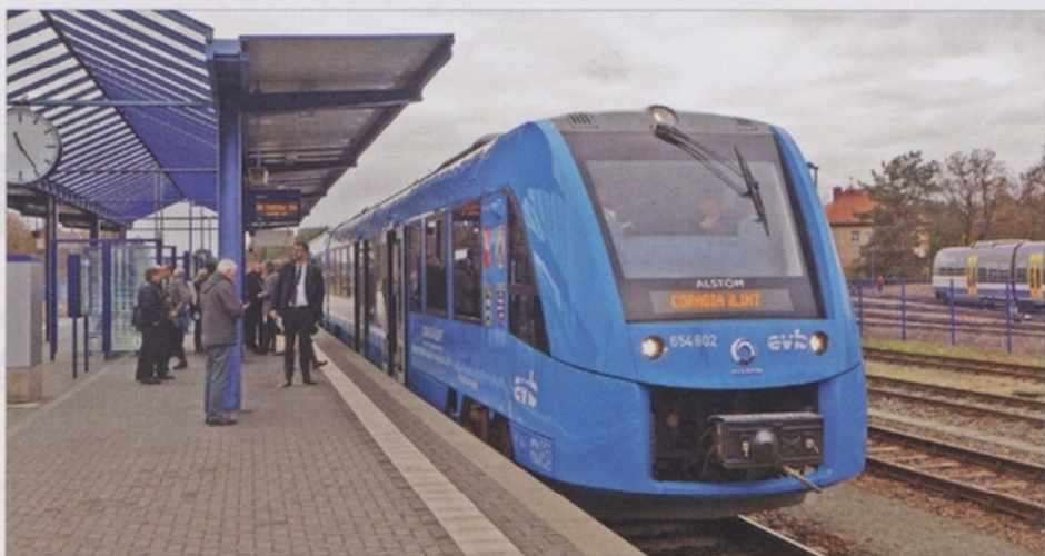
Die Zukunft beginnt auf der NEB 2024 mit sechs Doppel-Triebwagen: Der Coradia iLint von Alstom (hier auf Probefahrt in Basdorf) ist der erste Regionaltriebzug weltweit, der mit Wasserstoff-Brennstoffzellen angetrieben wird. Die Brennstoffzellen sind auf dem Dach montiert.
