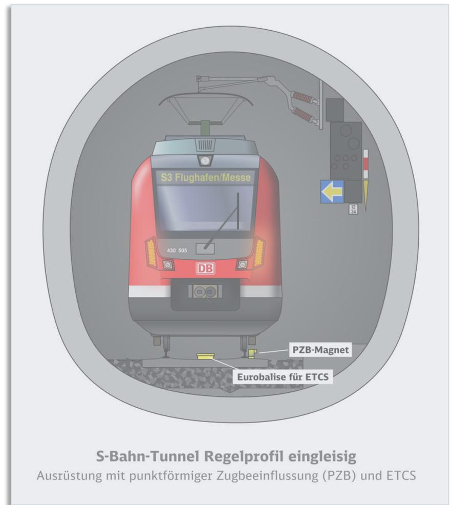
**S-Bahn-Tunnel Regelprofil eingleisig**
