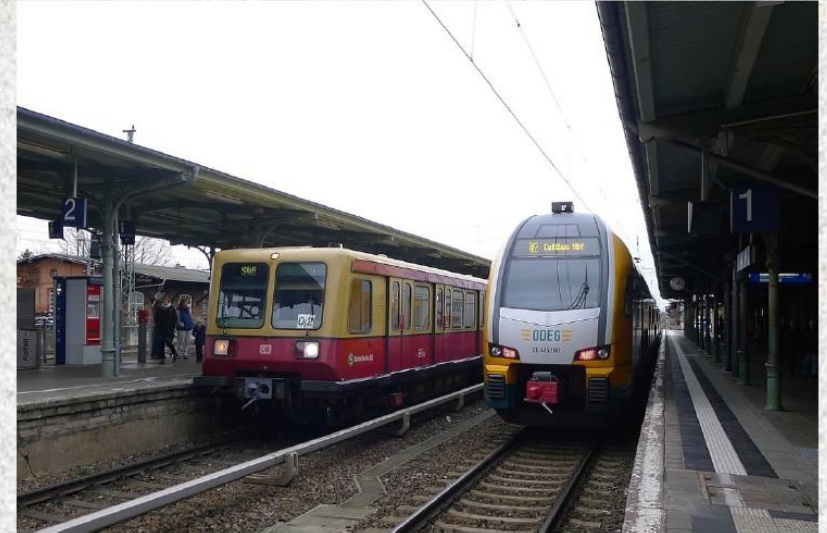
Abb. 7: Links Gleis 2 mit im Jahr 1951 auf 103 cm aufgemauertem Bahnsteig; rechts Gleis 1 (Bahnsteighöhe 76 cm ü. SO), RegionalExpress RE 2 der ODEG, Wismar – Schwerin – Wittenberge – Berlin-Spandau – Berlin Hbf – Königs Wusterhausen – Lübben (Spreew) – Cottbus.
